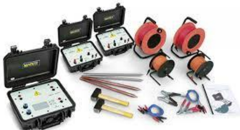
Figure 5: Équipement utilisé pour la prospection électrique
